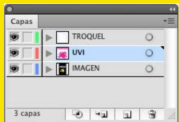
Ejemplo de 3 capas: - Imagen - UVI - Troquel
